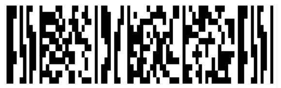
Code PDF417: Stapelcode mit starker Fehlerkorrektur. Besteht aus einzelnen Elementen, den "Codewörtern", welche aus je 17 Modulen aufgeteilt in 4 Striche und 4 Lücken bestehen.
